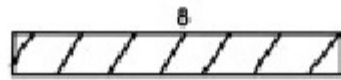
700.0911 Lasdraad testbundel carrosserie Lasband 8x2 mm, 36 stuks Lengte ca. 350 mm 9x HDPE Wit 9x PP Naturel 9x PC/PBTP (Xenoy) Zwart 9x ABS Wit
